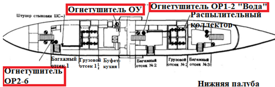
Рисунок 14 – Схема размещения систем пожаротушения на нижней палубе самолёта
