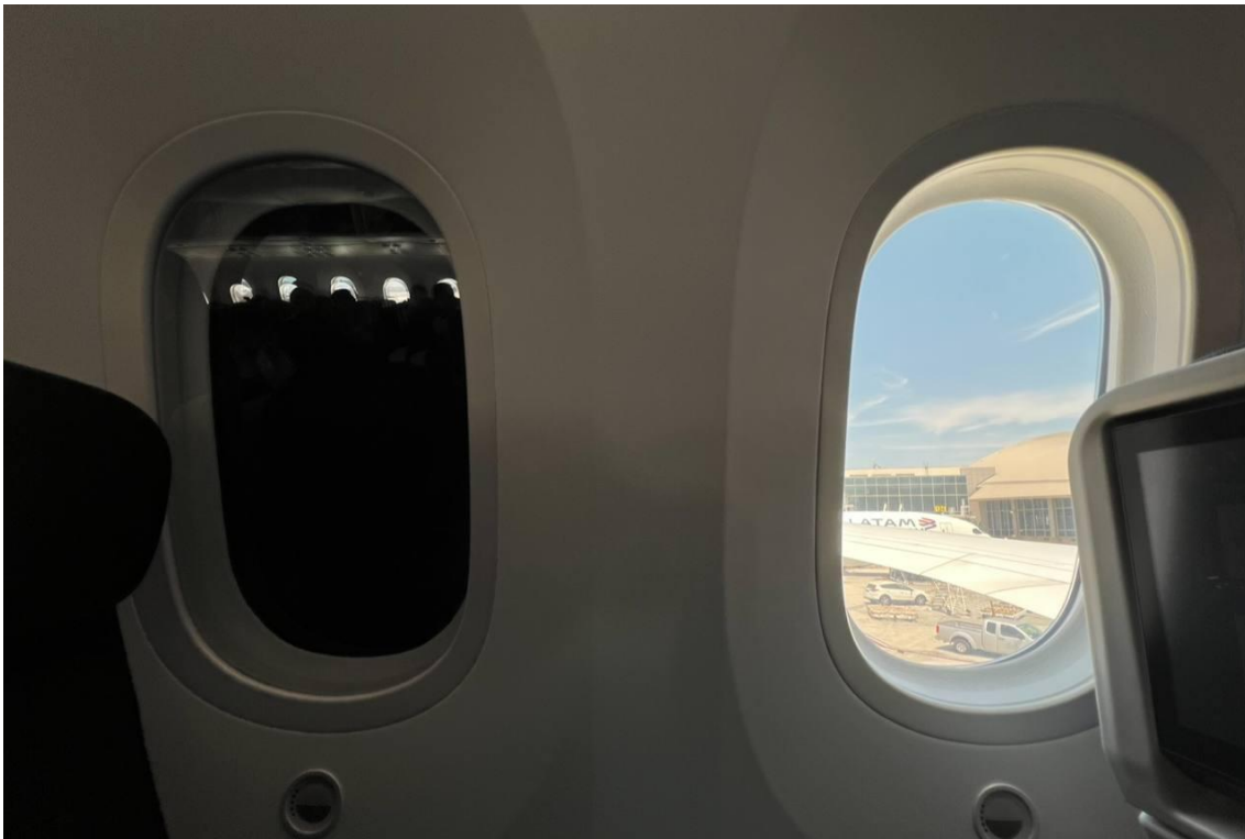
Рисунок 2 – Система Dimmable Window Boeing 787 Dreamliner
