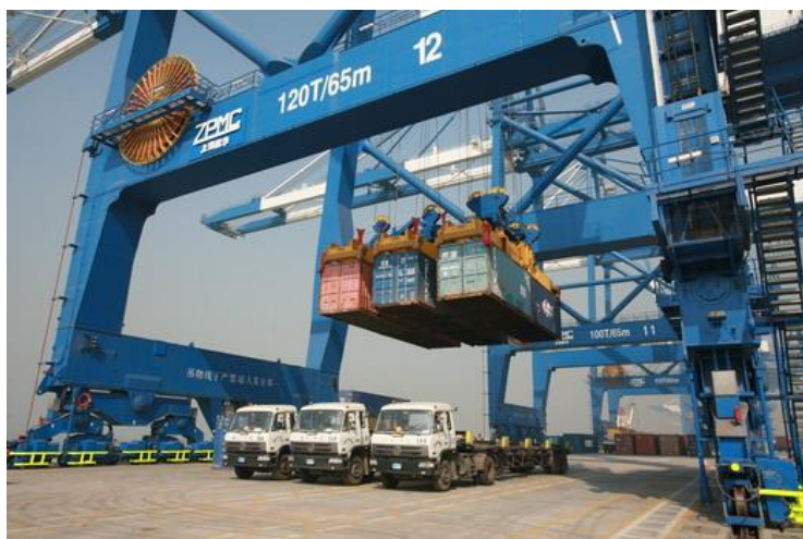
Рисунок 6 – Одновременный подъем сложным телескопическим ГЗУ шести 20-тонных или трёх 40-тонных крупнотоннажных контейнеров.
