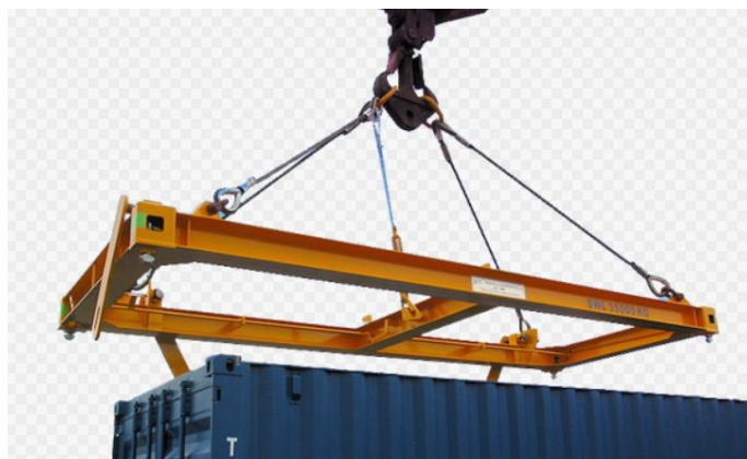
Рисунок 1 – Полуавтоматические спредеры для 20 и 40-тонных контейнеров
