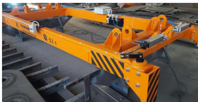
Рисунок 3 – Автоматический контейнерный спредер с центрирующими лапами
