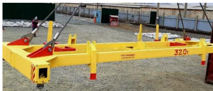
Рисунок 2 – Автоматический спредер для 20 и 40-тонных контейнеров
